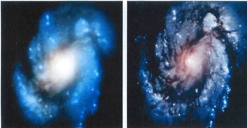
Figura 6.3 Prima e dopo la riparazione COSTAR (NASA)
