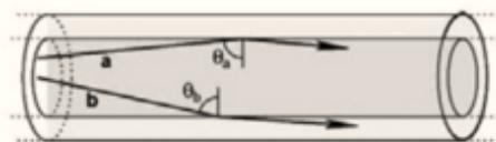
Fig. 4 Condizione di riflessione totale all'interno di una fibra ottica
