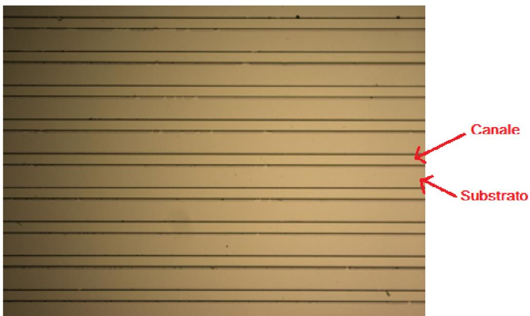
Immagine guida d'onda canale tramite microscopio ottico
