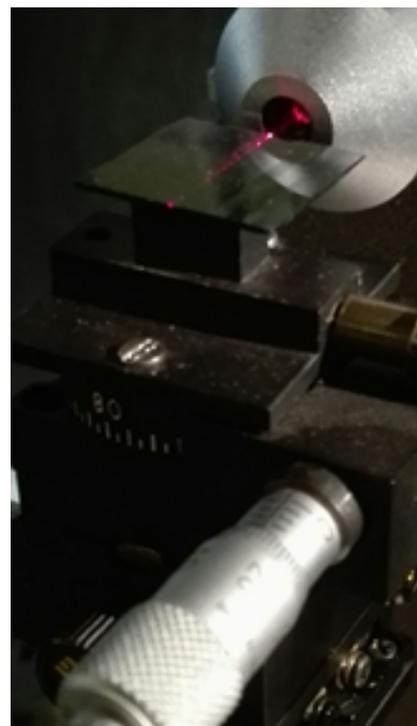
Inserzione della luce in guida d'onda
