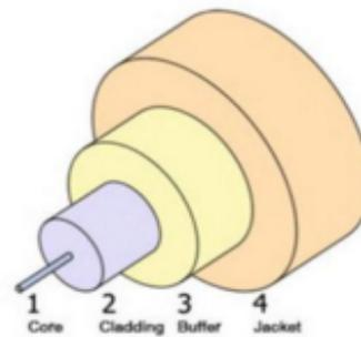
Fig. 2 Struttura di una fibra ottica
