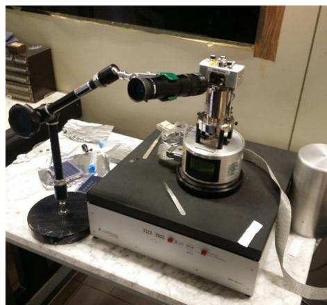
Microscopio a forza atomica ( AFM) utilizzato
