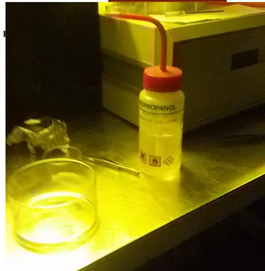
Isopropanolo e becher usati per il bagno di sviluppo.
