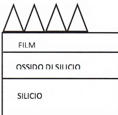
Si nota, in ordine, il reticolo di diffrazione di Ti/TMSPM, il film di Zr/GLY e il substrato costituito da Ossido di Silicio e Silicio.
