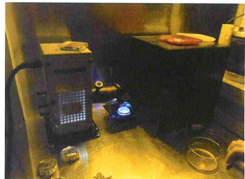
Dopo la fase dell'esposizione segue un'altra fase molto importante, **lo Sviluppo**: con questa fase si elimina il resist indesiderato mediante una soluzione alcolica, nel nostro caso l'**isopropanolo**. Il film esposto a luce UV (attraverso le aperture della maschera) viene immerso in una soluzione di alcool isopropilico e in questa soluzione le parti del film non esposte alla luce UV vengono rimosse, mentre quelle esposte rimangono inalterate.
