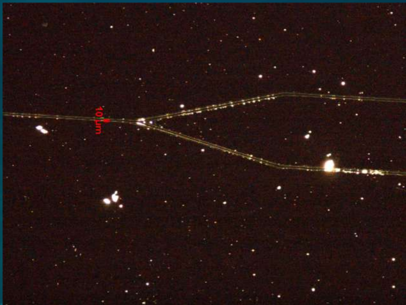
CAMPIONE 8 BEAM SPLITTER INGRANDIMENTO 5X
