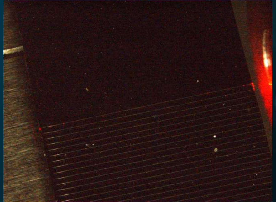
CAMPIONE 1 GUIDE PICCOLE INGRANDIMENTO 5X INSERZIONE DELLA LUCE IN GUIDA
